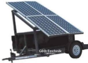
Photovoltaik Stromerzeugung. Mobile Solarstrom Anlage als Anhänger mit Solarmodulen, Batterien und Wechselrichter 230 Volt 3000W.
